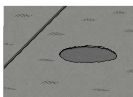
既存露出防水層 (砂付ルーフィング)
