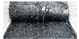
施工後10年程度経過したガムクールを 切開調査したガムロン粘着層の事例。
