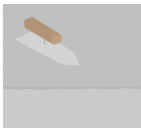
下地樹脂モルタル塗り
