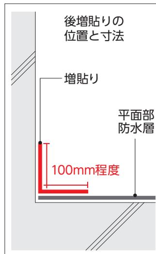
※工程IIをオールコート立上り用(1.2~1.3kg/m<sup>2</sup>)+マットFCII+オールコート立上り用(1.2~1.3kg/m<sup>2</sup>)に替えることができます。
