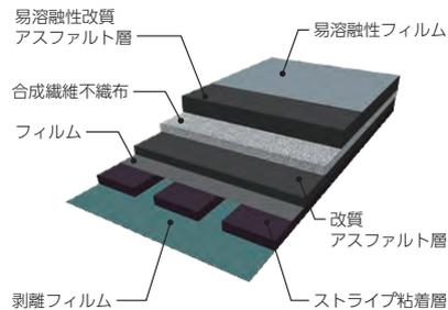
表面に特殊処理フィルムをラミネートした、BANKS工法用ストライプ状粘着層付改質アスファルトルーフィング。
