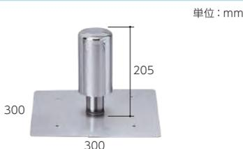
防水層のフクレを解消するための平面部用ステンレス製通気材。70~80m<sup>2</sup>に1ヶ所の割合で設置。積雪寒冷地対応品。Gタイプは逆流防止付。
