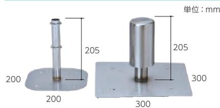
断熱工法に使用する、二重式の平面部用ステンレス製通気材。70~80m<sup>2</sup>に1ヶ所の割合で設置。積雪寒冷地対応品。GWタイプは逆流防止付。
