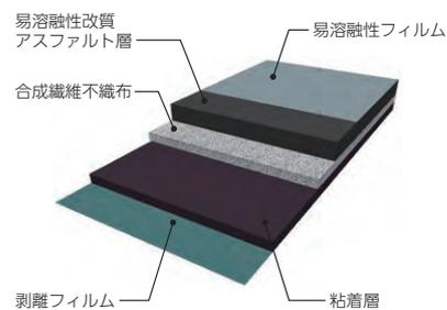
BANKS工法用の全面粘着層付改質アスファルトルーフィング。
