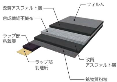
機械的固定工法用改質アスファルトルーフィング。裏面はラップ部分にのみ粘着層が設けられている。
