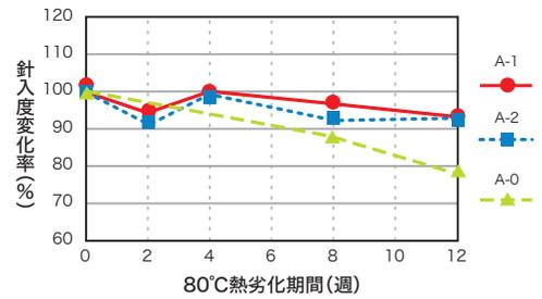
②改質アスファルトシート粘着材の針入度変化
