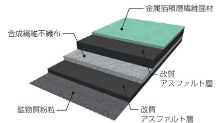
表層を金属箔積層繊維面材で仕上げた非砂付タイプ改質アスファルトルーフィング。レイヤオール工法に使用する。製品は逆巻きとなっており、緑色面を表側にして施工する。
