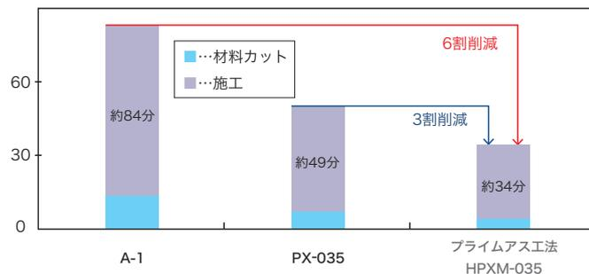
プライムアス工法HPXM-035仕様は、公共建築標準仕様A-1(4層)と比較して、施工時間の約6割削減が可能です。また、2層仕様のPX-035(ストライプ工法)と比較しても、施工時間を3割削減することが可能です。
