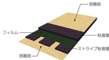
両面に粘着層を設けた、露出断熱防水用の防湿シート。
