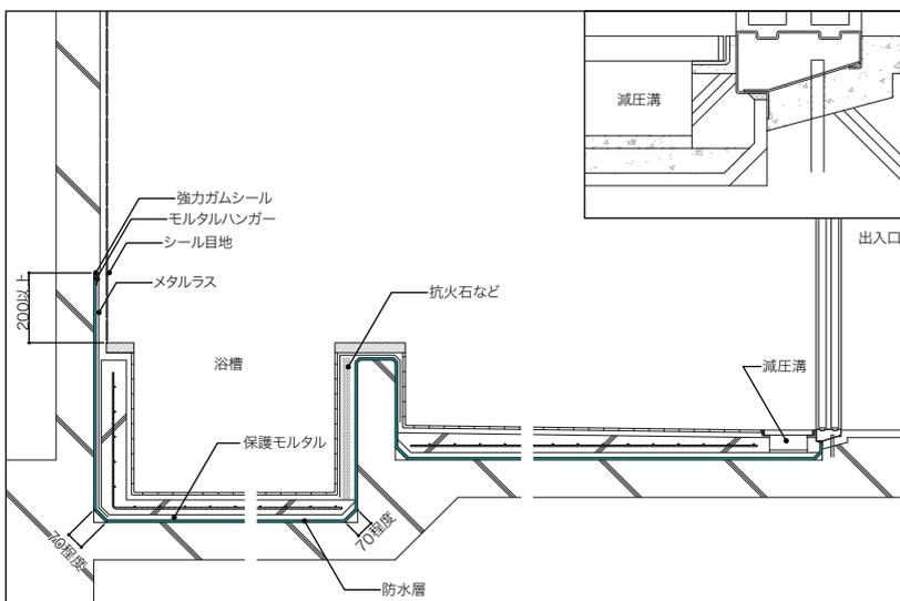
屋根と異なり温度変化が少なく、下地の動きが小さい利点はあるが、設備が多くなされるため、パイプなどが下地を貫通し複雑な納まりとなる箇所が多い。
