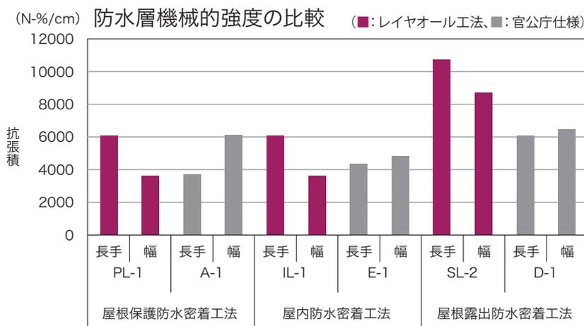
レイヤオール工法はシートと塗膜材を併用することで、公共建築工事標準仕様と同等以上の抗張積を確保しています。
