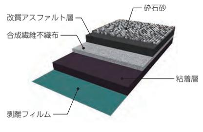
裏面に粘着層タイプの砂付改質アスファルトルーフィング。
