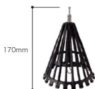
リードレンZ専用の連結式縦引用キャップ。軸芯部のJフックをリードレンZの丸棒部に掛け、Wナット締めで連結固定する。アルミダイキャスト製。
