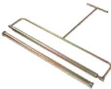
転圧を掛けながら、剥離紙・フィルムをロールに巻き取る粘着層付ルーフィング専用工具。巻き取られた剥離材は、ロールを外し処分する。
