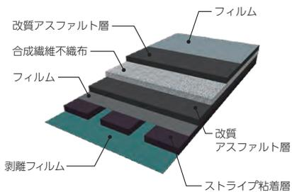
レイヤール工法、エコフィット工法共用の、ストライプ状粘着層付改質アスファルトルーフィング。
