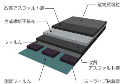
絶縁・通気工法用のストライプ状粘着層付ルーフィング。
