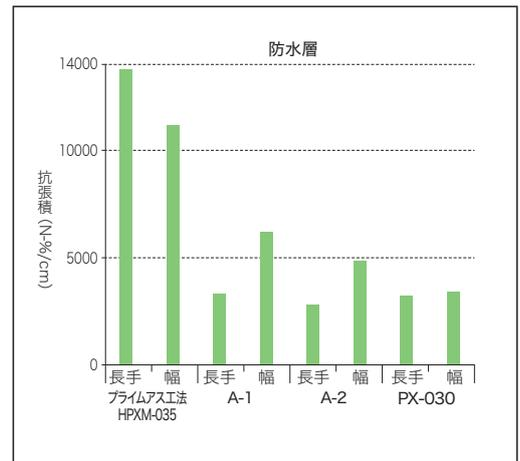
プライムアス工法は公共建築工事標準仕様の A-1, A-2 および東西アス 2 層仕様の PX-030 と比較しても同等以上の機械的強度を有しています。
