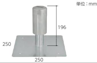
全体の形状を小型・軽量化した平面部用ステンレス製通気材。70～80㎡に1カ所の割合で設置。
