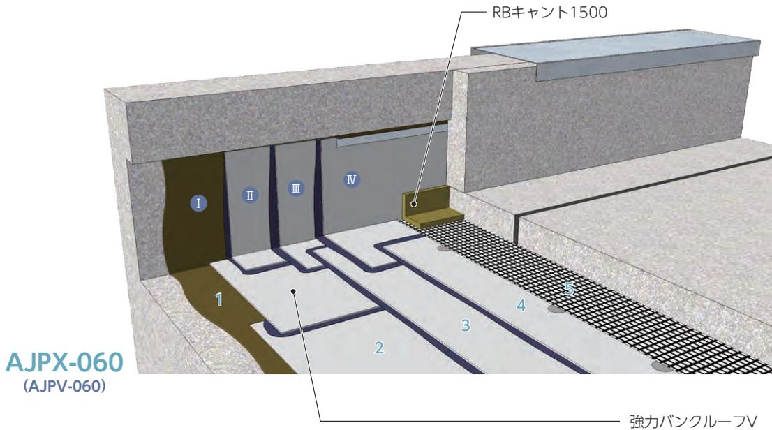
ノンケトル冷熱併用工法
