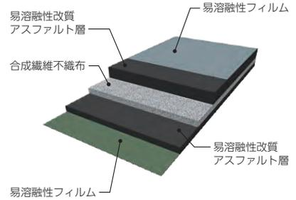
BANKS工法用の立上り用改質アスファルトルーフィング。裏面をあぶって貼り付ける。
