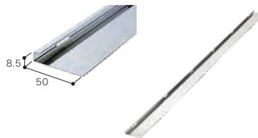
ステップスクエア500H、ガムロンタイルの端部保護を兼ねたステンレス製見切材。VTテープ50を用いて固定する。側面に水抜用の穴6カ所あり。
