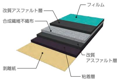
レイヤール工法、エコフィット工法共用の、粘着層付改質アスファルトルーフィング。
