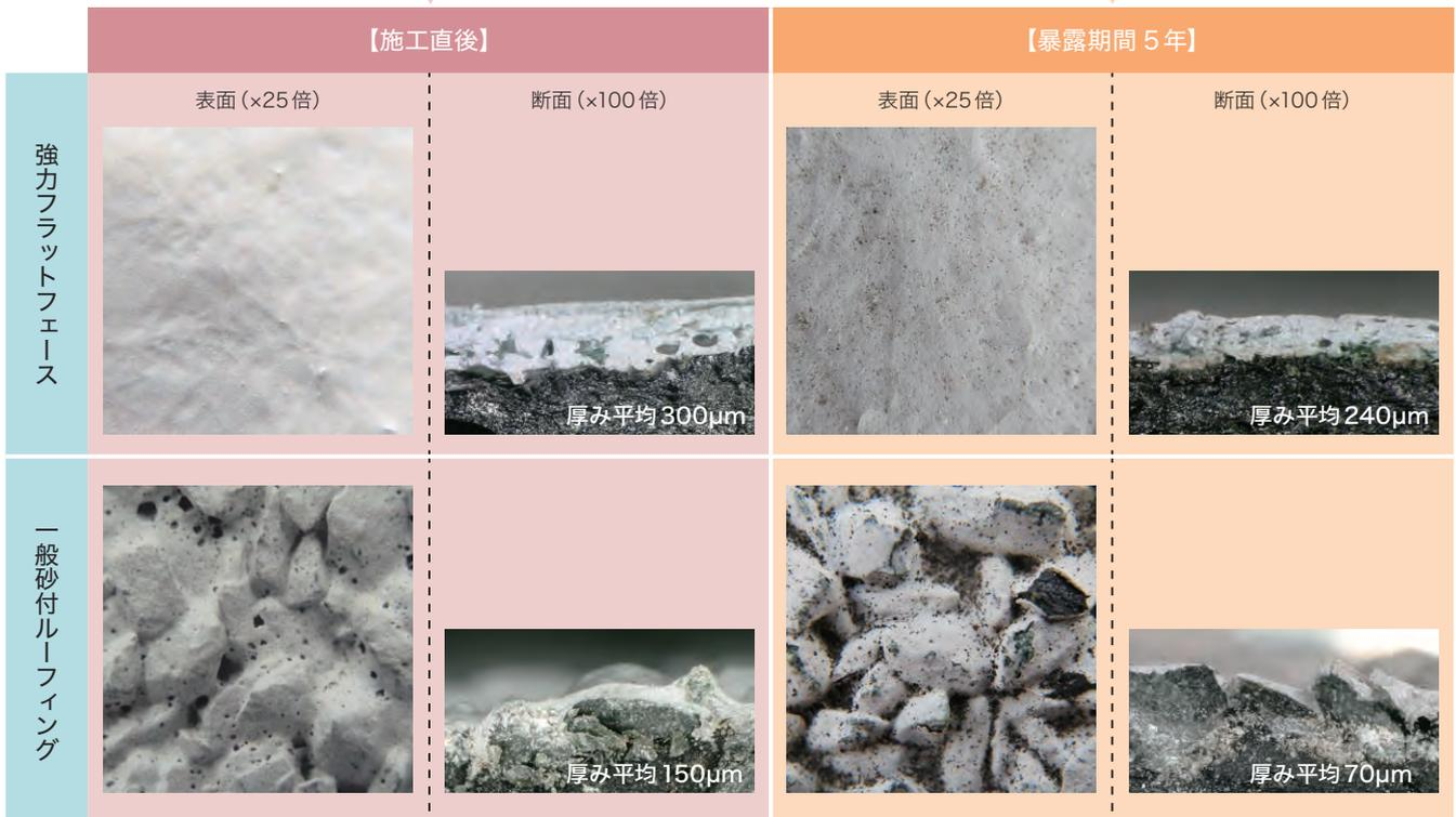
(屋外暴露試験：各試験体に保護塗料を所定量塗布し屋外に設置。一定期間経過後、表面の観察ならびに切断による断面観察を行った。)
