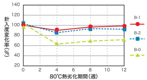
アスファルト系下地処理材を用いたかぶせ改修を行うことで、既存層・新規層ともに延命効果が生じることが確認できました。本工法は機械固定工法と異なり、既存防水層に穴を開けることなく、既存防水層の余命を活かす工法です。
