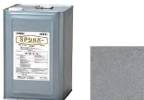
アスファルト系防水用溶剤系保護塗料。低温時でも施工が可能。塗布量:0.3kg/m<sup>2</sup>。
