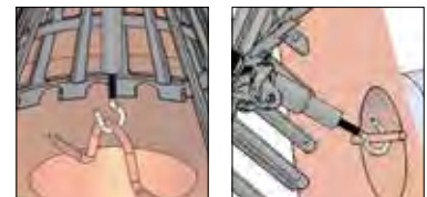
リードレンキャップZたての軸芯部と連結 リードレンキャップZ横の軸芯部と連結
