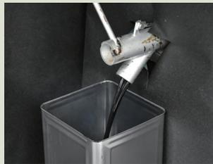
アスファルトの煙にはオイルミストが多く含まれています。オイルミストの発生量は加熱減量で測定できます。施工温度上限での加熱減量を比較すると、クリンタイトJは、従来の工事用3種アスファルトに比べて大幅に低いことがわかります。
