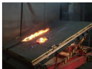
屋根の防火(飛び火)性能試験風景
