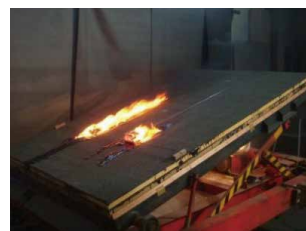
屋根の防火（飛び火）性能試験風景
