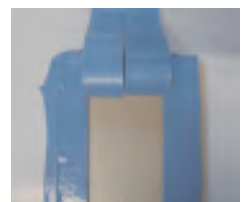
OTプライマー-AとビュートップUシートの界面剥離
