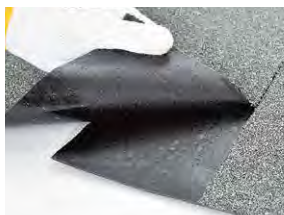
転圧直後の遅延粘着層
