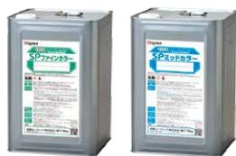
アクリル樹脂を主成分とする、アスファルト系防水材専用水性塗料。SPファインカラーは日射反射率50%以上の高反射塗料。
