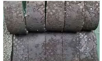
180°引き剥がし試験後 層間の接着状況：凝集破壊
