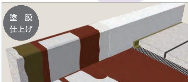
下貼りの強力プライムルーフィ1層とプライムタイトの塗膜で仕上げる仕様です。
