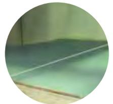
レーザーラインはほぼ直線。接着工法において、防水層の浮き上がりは発生していない。
