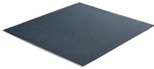
アスファルトに無機質充填材を配合し板状に成型したパネル材。裏面は砂粒層で下地水分を拡散。容易に施工でき、耐衝撃性・耐圧縮性に優れる。
