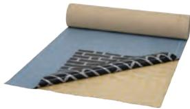
複合防水の下貼り用通気緩衝シート。軽量で寸法安定性が高く、裏面はゴムアスのストライプ状粘着層。下地追従性に優れ、水分の拡散効果を発揮。
