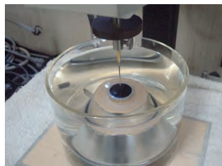
劣化判定(針入度測定)
