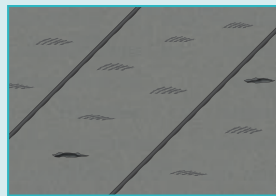
既存露出防水層 (砂付ルーフィング)
