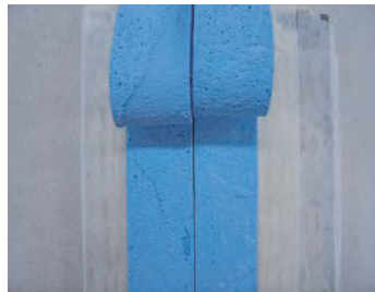
オルタック防水凝集破壊
