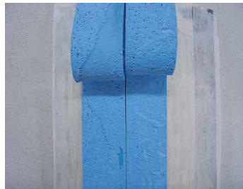
オルタック防水凝集破壊
