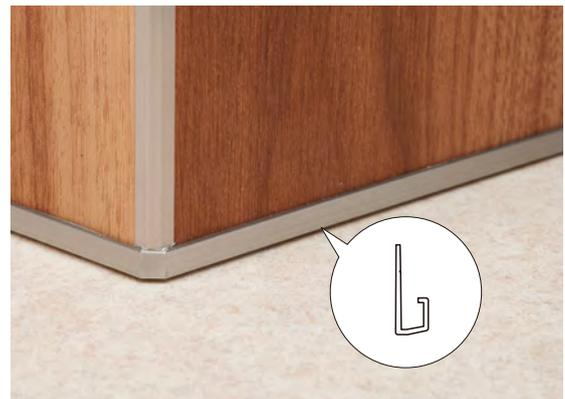
エッジバーは、腰壁の上端だけでなく下部にも施工することで、よりデザイン性を高めることが可能。フロアの美観向上に大きく貢献します。また、下部に施工した場合に、できるだけ床面の不陸を目立たなくする工夫として、バー上面にわずかに角度をつけて前方に傾斜する形状としています。
