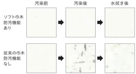
**試験概要** 試験片(ソフト巾木)をドラムの内側に貼り付け、ゴムブロック(靴底を想定)を6個ドラムに入れて10分間攪拌。汚染後、固く絞った不織布で水拭き。 JIS K 3920に準拠
