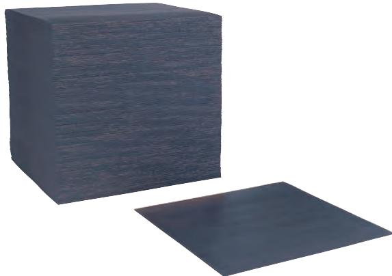
アスファルトに鉱物繊維・粉末、植物繊維などを充填したものを板状に圧延し、両面に原紙(アスファルト含浸)を貼り付けた土木用目地材です。
