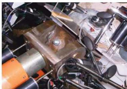
■アンカー一部荷重変形特性試験
